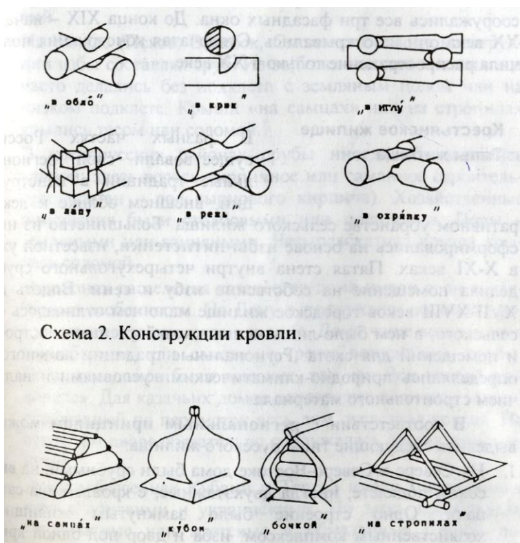
Схема 1. Способы вязки бревен.
